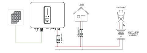
**Electrical Wiring Diagram**
