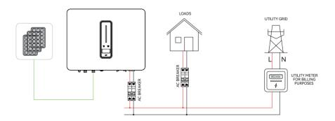
**Electrical Wiring Diagram**
